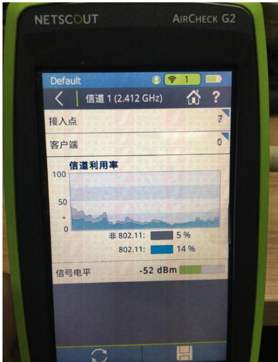
5、显示正在该信道上运行的接入点。可能的改善措施：重新分配部分接入点的信道，找到未授权的接入点并删除。
