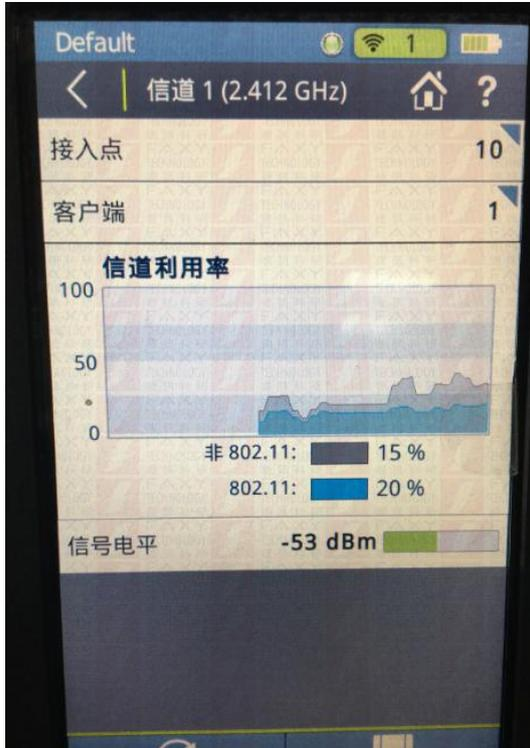
5、显示正在该信道上运行的接入点。可能的缓解措施：1.在部分接入点上重新分配信道。2.找到未授权的接入点并删除
