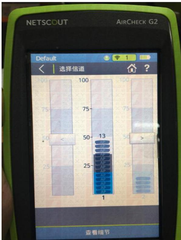
4、显示所选信道的详细信息，包括使用率、该信道上接入点和客户端的数量。如果 802.11 使用率 > 25%，且接入点 > 2，即表示有问题，您应该选择“接入点”查看接入点的详细信息。
