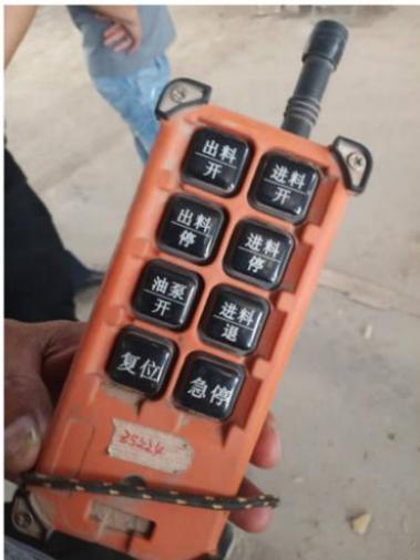
遥控器，灵活控制输送进料和退料卡料/堵料等问题，工人操作简单方便。
