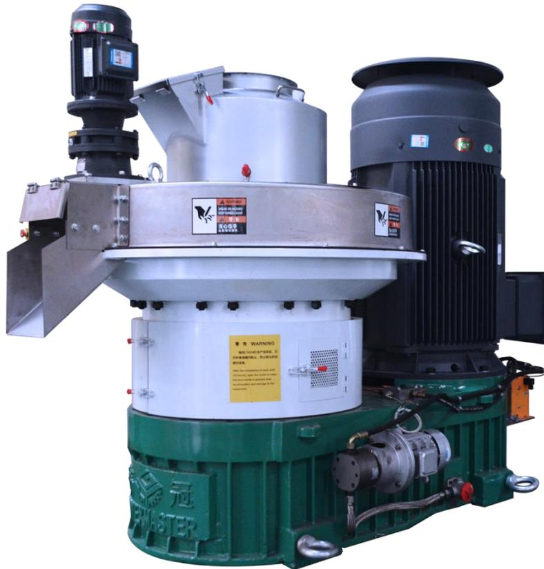
1. 压辊采用新式无锁姆封闭式压辊（又称免注黄油压辊），压辊轴承寿命大大延长，注油方式可采用间接式打油，可1天或几天打油一次（打油2分钟），或者采用一周清洗压辊总成一次，（老款颗粒机填充油脂的注油方式间隔半个小时注油一次，一次注油2分钟）。
