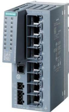
SCALANCE XC208G 可管理层面 2 IE 交换机； IEC 62443-4-2 认证； 8x 10/100/1000 Mbit/s； RJ45 端口； 1X 控制台端口； 诊断 LED； 冗余电源； 温度范围 -40° C 至 +70°C； 安装： 凹顶导轨/S7 型轨/墙壁 冗余功能； 办公室 特性 (RSTP, VLAN, ...); PROFINET IO 设备； Ethernet/IP 一致性； C-PLUG 插槽；
