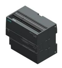
SIMATIC S7-200 SMART, CPU SR40, 上, AC/DC/继电器, 机载 I/O: 24 个 24V DC 数字输入; 16 个 2A 继电器数字输出; 电源: AC 47-63Hz 时, 85-264V AC 程序存储器/数据存储器 40 KB 网络服务器支持
