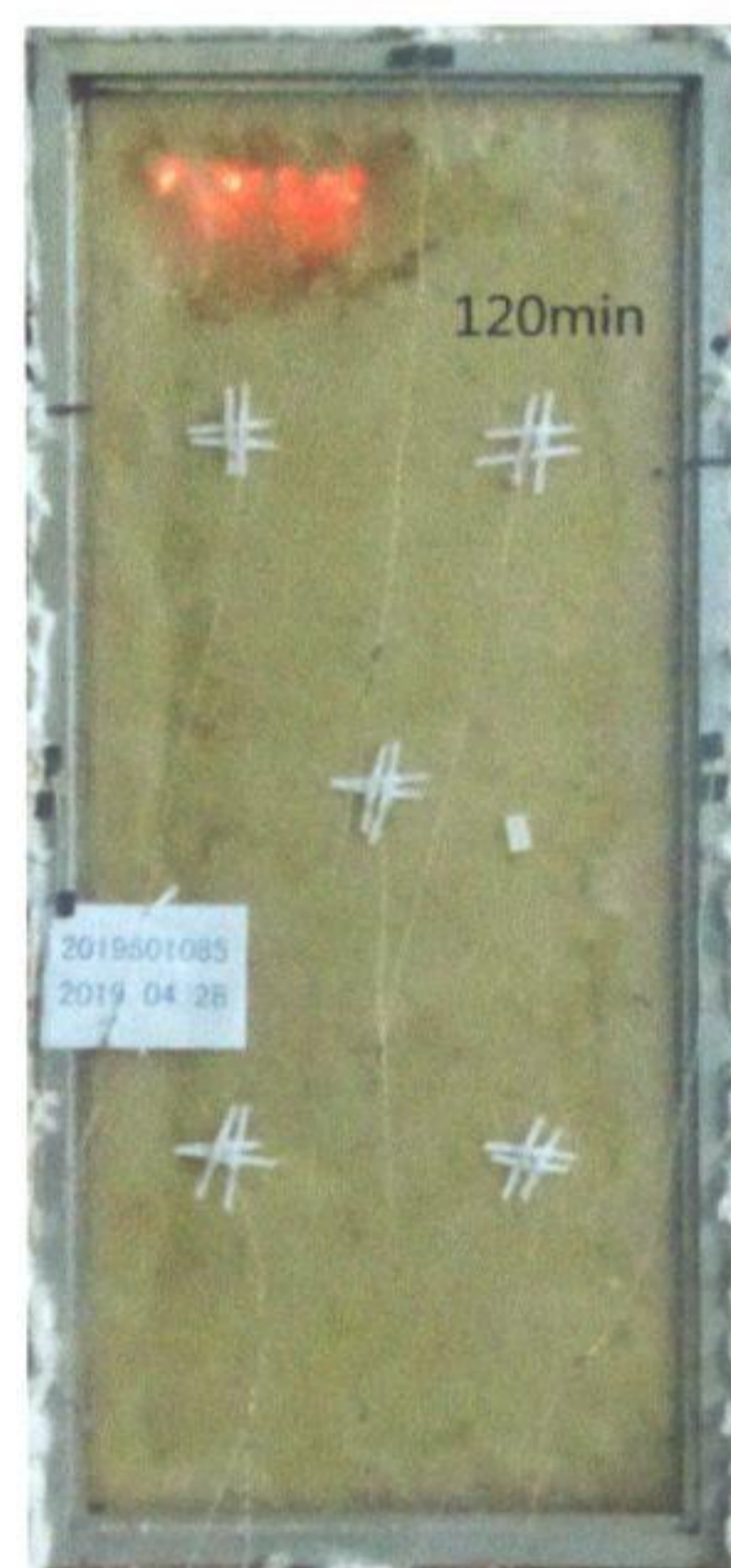
照片 2 耐火性能试验结束时试件情况
