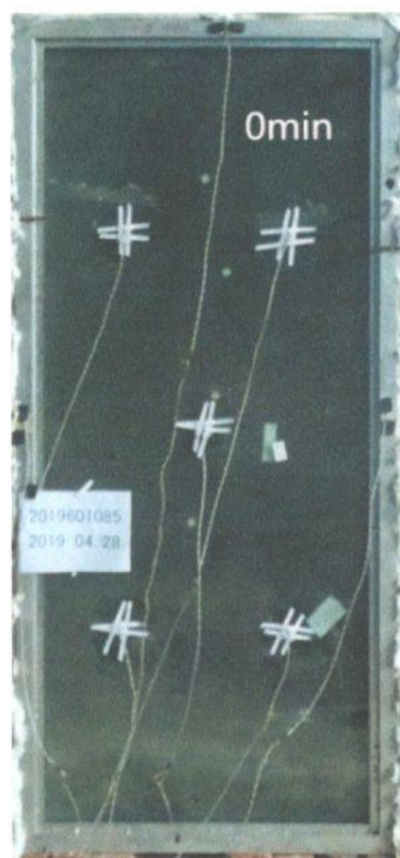
照片 1 耐火性能试验前试件情况
