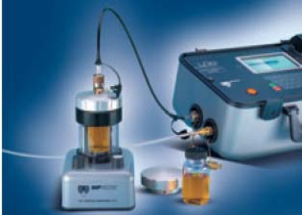
110 毫升标准取样瓶配有脱气装置，仅用于矿物油。
