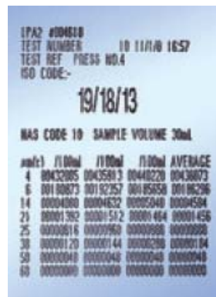
3 在线状态下的动态检测 取三次检测结果的平均值。 ISO 4406 编码。
